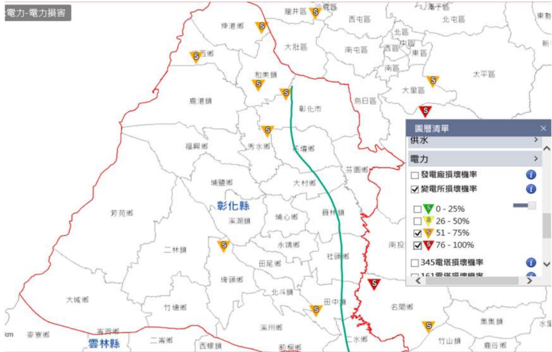
圖 3-11 地震模擬「變電所」損壞機率圖
